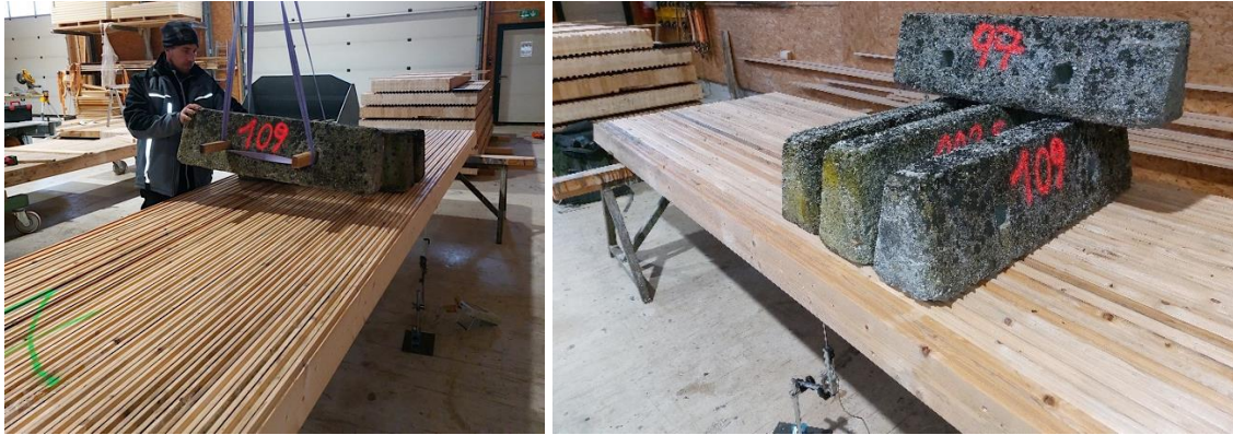
Abbildung 24 Aufbringen der Belastung mittels abgewogener Betonblöcke
