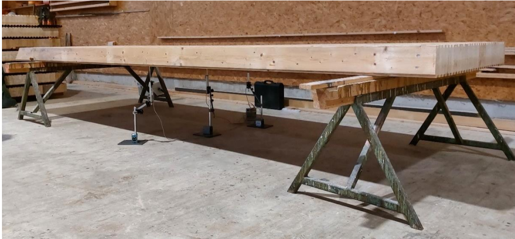
Abbildung 20 Versuchsaufbau für den ersten Belastungszyklus des Bauteils
