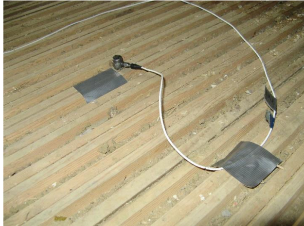
b) Detailabbildung des Körperschallaufnehmers
