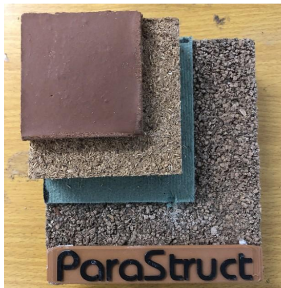
Abbildung 1: Handmuster des von ParaStruct entwickelten mehrschichtigen Fußbodenaufbaus.
