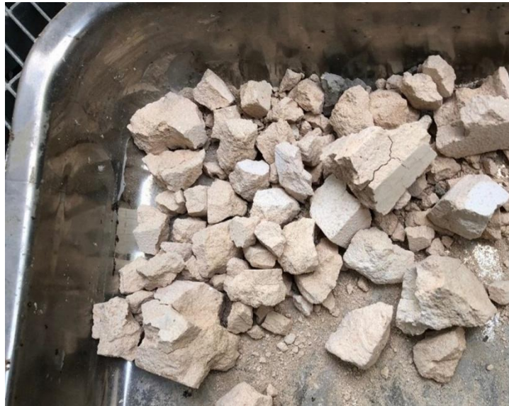
Abbildung 27 Bruchstücke von Normprüfkörpern nach der Rekalzination.
