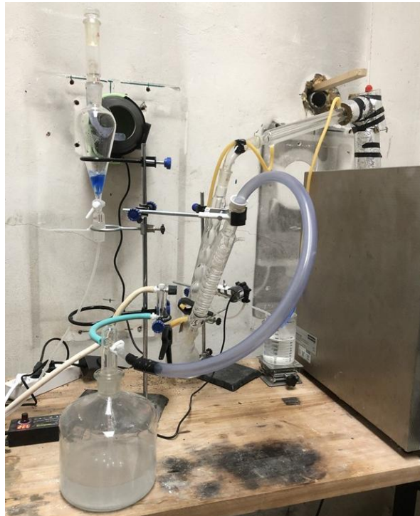
Abbildung 28 Labortest eines möglichen Aufbaus zur Abgasaufbereitung für den Rekalzinierofen.
