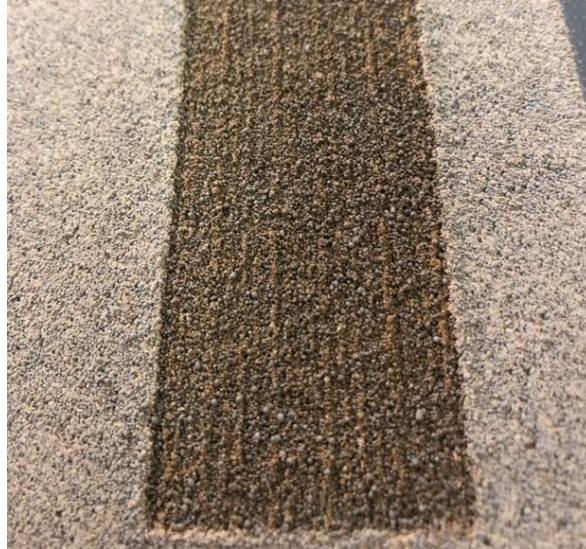
Abbildung 25 3D-Druck eines Prüfkörpers aus Estrichmaterial.
