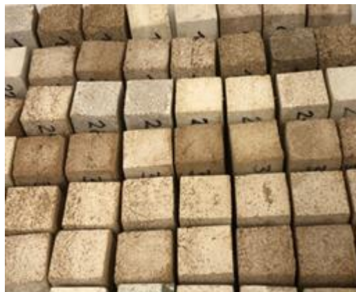
Abbildung 2: Normprüfkörper verschiedener Mischungen bereit für die Festigkeitstests.
