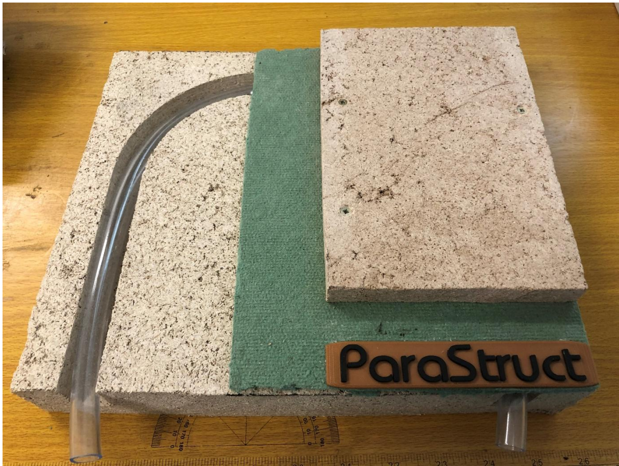
Abbildung 30: Rückbaubarer Segmentboden mit eingefräster Rohrführung
