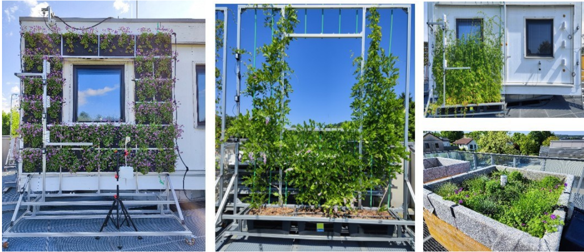
Abbildung 1: Fassadenprüflinge und Dachteststände aus dem Projekt MARGRET. Fotos: M.Majcen, AEE INTEC.
