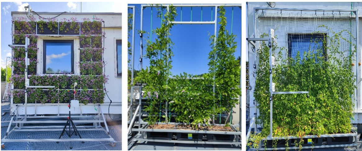
Abbildung 2: Drei der fünf Probenwagen: Living Wall (links), Wisteria sinensis mit Rohren als Rankhilfe und Fensterausschnitt (Mitte) und Parthenocissus q. mit Rankgitter ohne Fensterausschnitt (rechts). Fotos: M.Majcen, AEE INTEC.
