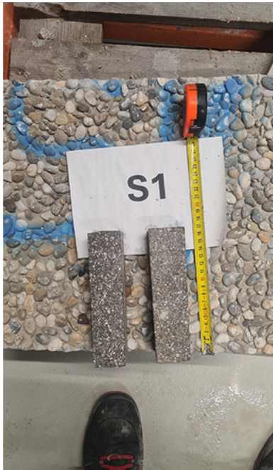
Abbildung 90: Geschnittene Proben für Materialprüfung, TU Wien
