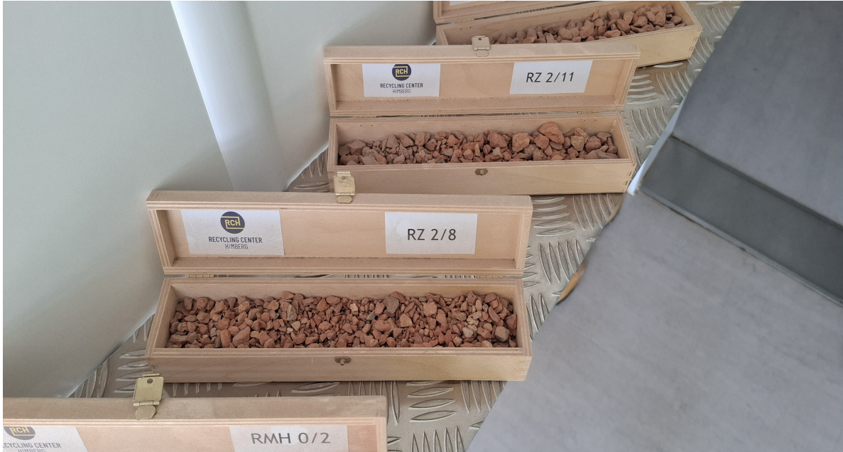
Abbildung 32: Materialmuster Recyclingziegel (RZ) in den Korngrößen 2/8mm und 2/11mm (© Katharina Möller, grünplan)
