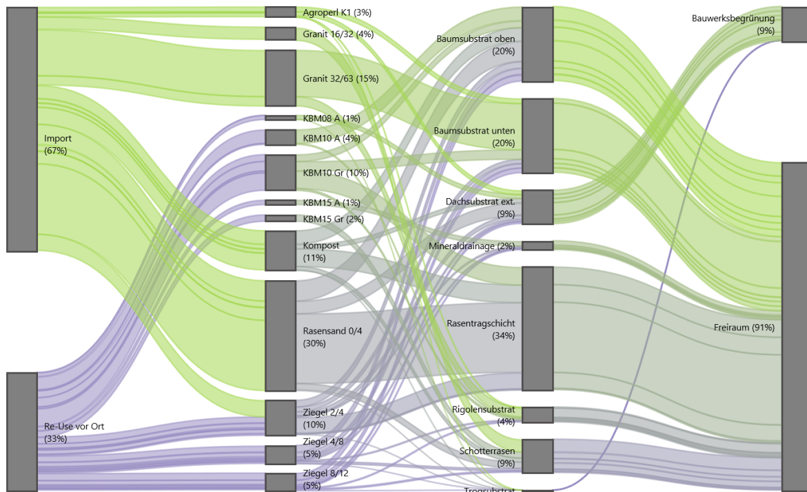
Abbildung 40: Visualisierung (Sankey-Diagramm) der Stoffströme im Zuge des Bezugs von Substraten im Szenario Ideal (e7)
