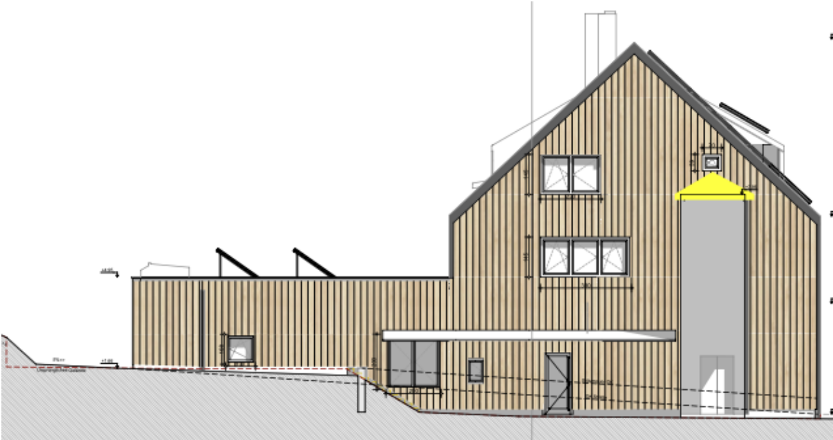
Abbildung 36: Südansicht sanierte RAIKA (rechter Bereich) und Zubau Musikvereinsgebäude (linker Bereich) (Quelle: Nussmüller Architekten)
