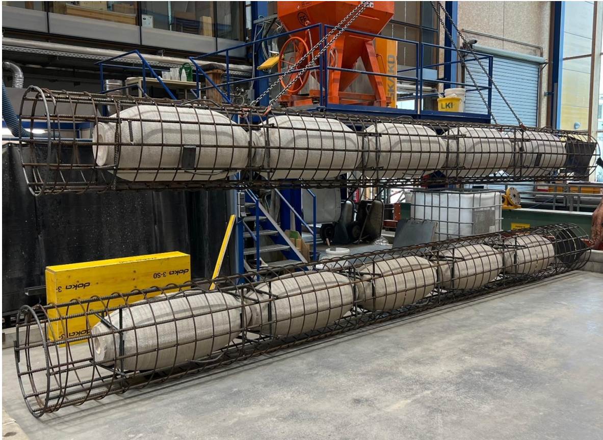
Abbildung 16: Mit Aussparungskörpern bestückter Bewehrungskorb für den Feldversuch ©Philip Wehbe, ITE TU Graz
