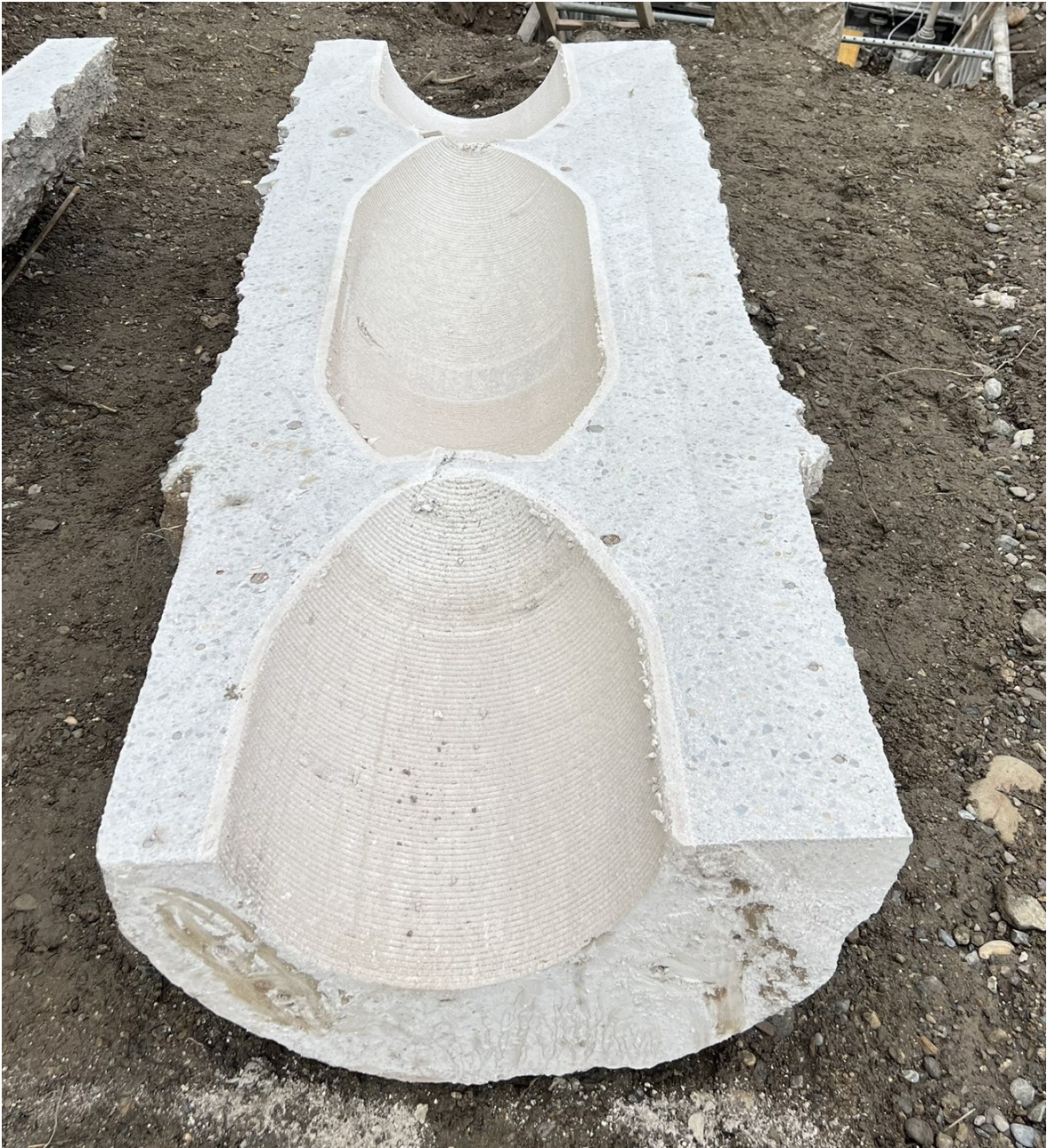
Abbildung 21: Freigeschnittenes Bohrpfahlsegment ©Philip Wehbe, ITE TU Graz
