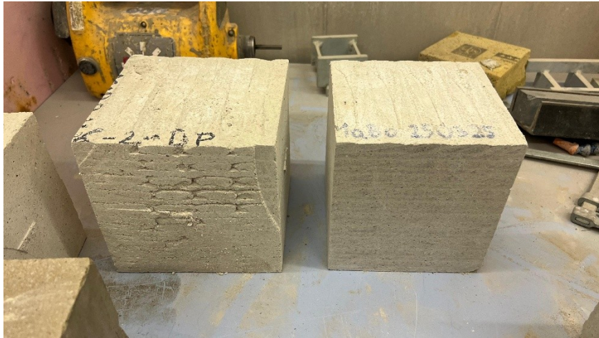
Abbildung 6: 3D-Betongedruckte Prüfkörper für den Druckversuch ©Philip Wehbe, ITE TU Graz
