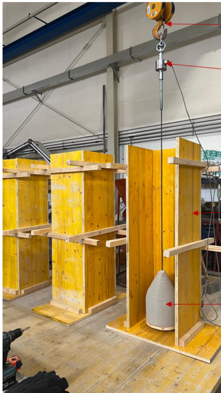
Abbildung 12: Darstellung des Versuchsaufbaus zur Ermittlung eines Reibungskoeffizienten ©Philip Wehbe, ITE TU Graz
