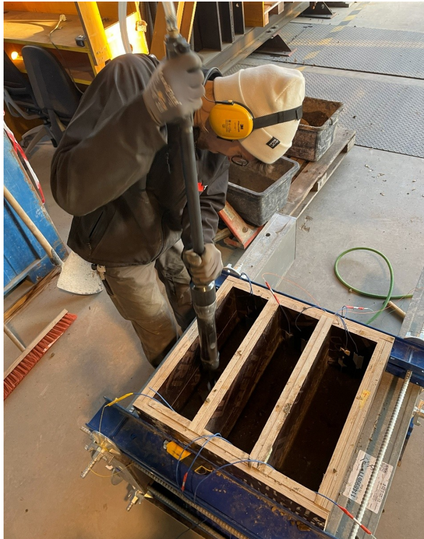
Abbildung 3: Herstellung der Prüfkörper mit pneumatischem Stampfhammer
