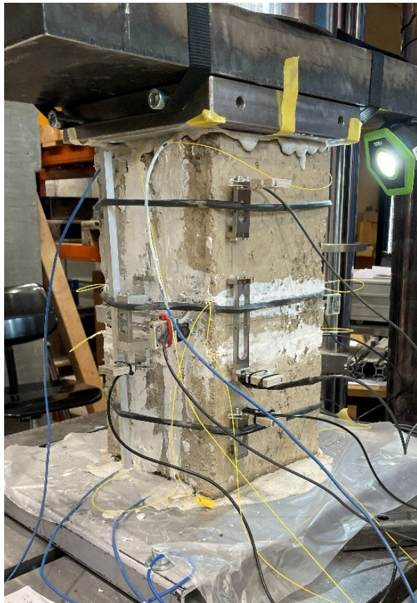
Abbildung 8: Druckversuch vom Prüfkörper D1 mit aufgeklebten (Farbe gelb) und eingestampften (Farbe blau) Sensorkabeln
