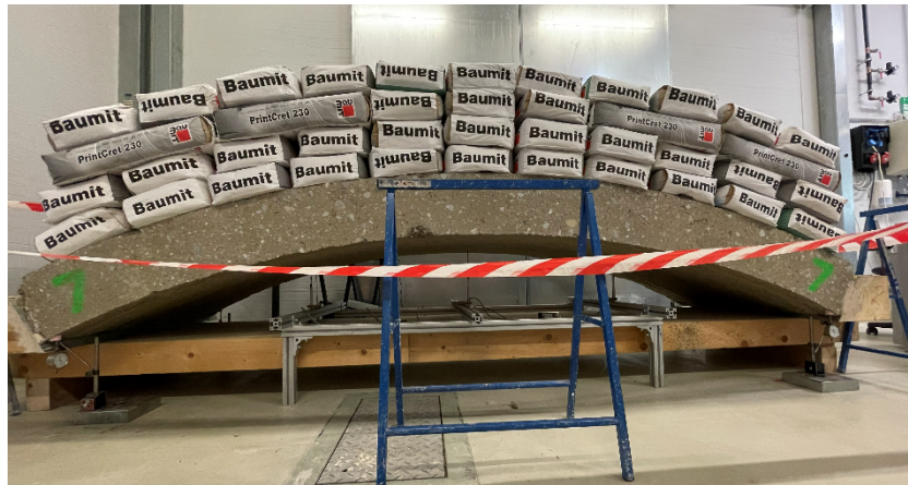
Abbildung 26: Belastung der Lehmkappendecke
