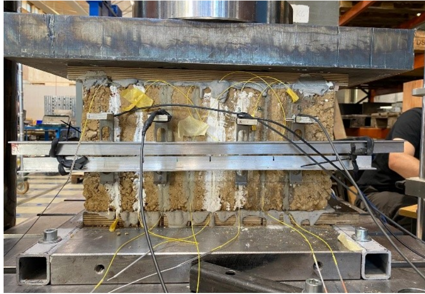
Abbildung 2: Druckversuch am Prüfkörper V1 mit vier unterschiedlichen Klebstoffen von Sensor-kabeln (von links: Flexkleber, Fliesenkleber; Gusskeramik und Ankerkleber)
