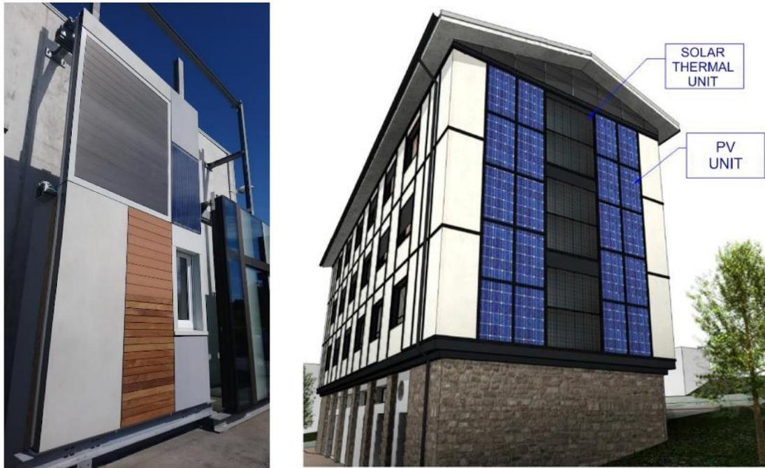
Abbildung 5: Beispiel von Fassadenelementen mit aktiven und passiven Anlagenkomponenten. Bildquelle: [73]. Bildrechte: (CC-BY).
