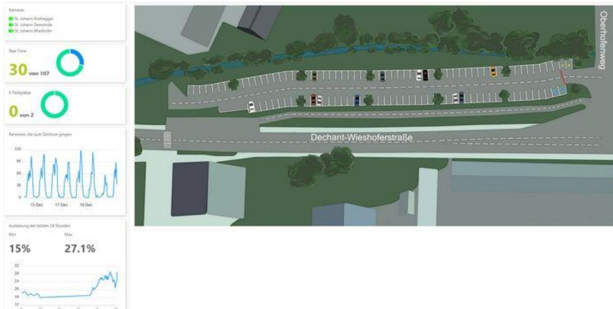
Abbildung 10: Parkleitsystem zur Optimierung des Verkehrsflusses und damit zur Reduzierung des Energieverbrauchs im Transportwesen.
