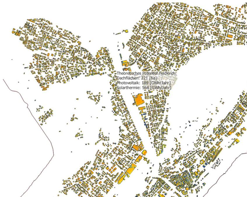
Abbildung 14: Theoretisches Energiepotenzial der PV- und Solarthermieanlagen auf den Dächern der Stadt Feldkirch (Telesis Entwicklungs- und Management GmbH, 2024)
