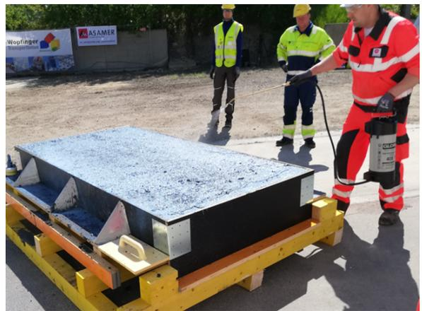
Abb. 18: Schritt 4 = Aufbringen des Verdunstungsschutzes an der Decke RCC2+
