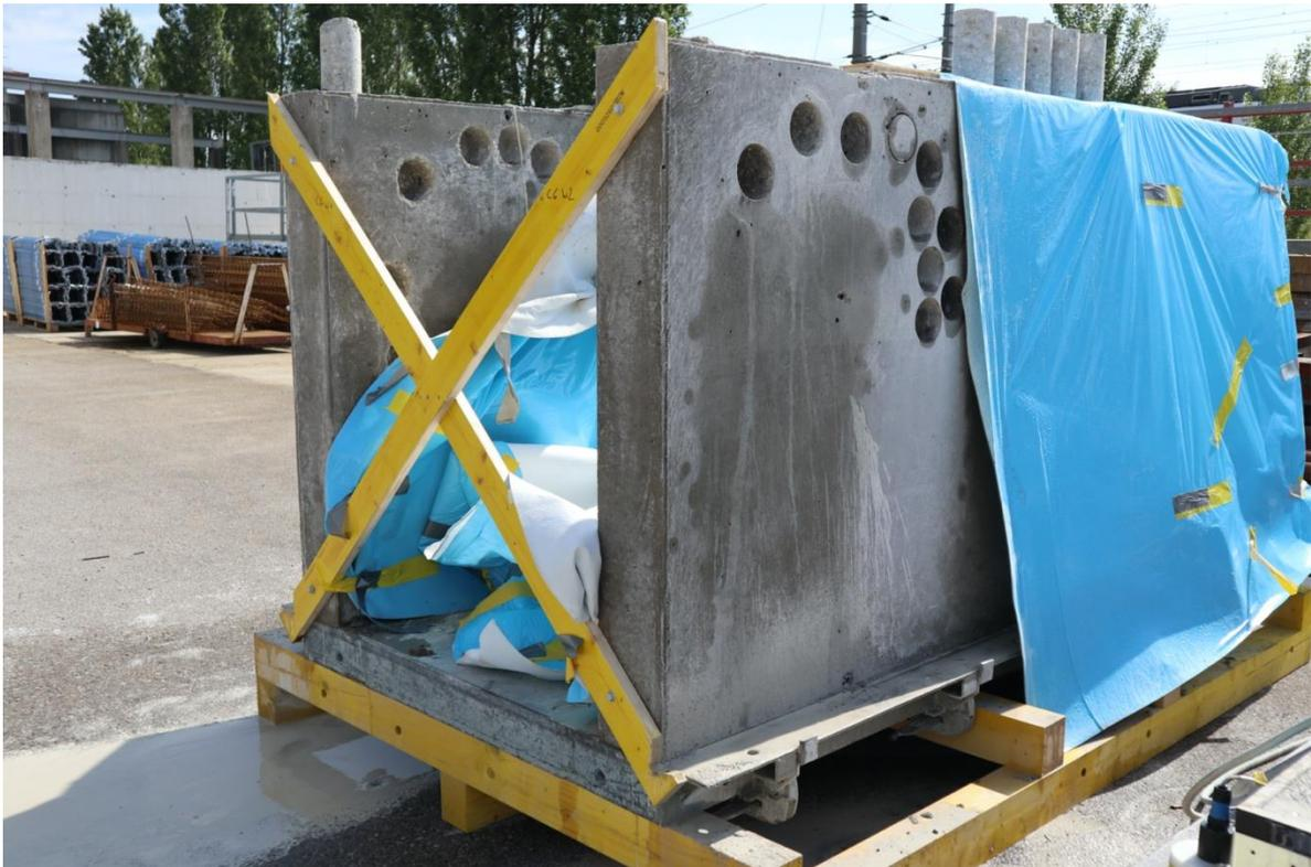
Abb. 29: Bohrkernentnahme an Wandbauteilen der Rezeptur RCC (Fotocredits: ROMM ZT)
