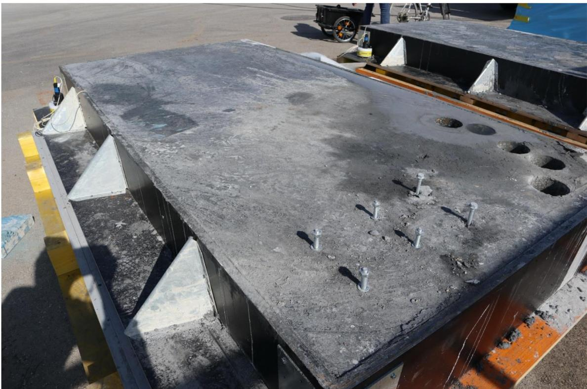
Abb. 32: Ausziehversuche an einem Deckenbauteil der Rezeptur RCC2+ (Fotocredits: ROMM ZT)
