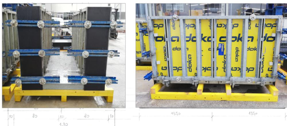
Abb. 7: Aufbau Wandschalung auf Trägerrost zum Manövrieren und Umheben mit Gabelstapler; links Ansicht Stirnseite, rechts Ansicht Fläche
