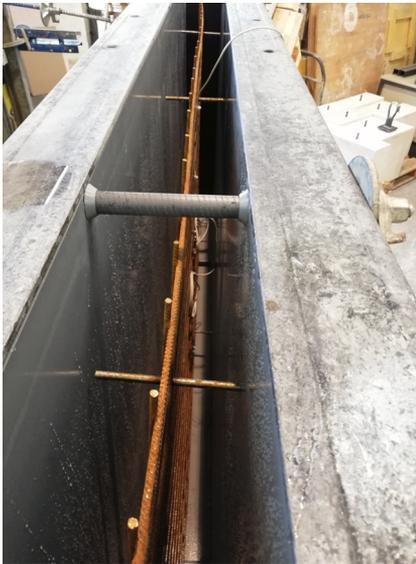
Abb. 8: Montage Messstellen an der Bewehrungsmatte, Wand
