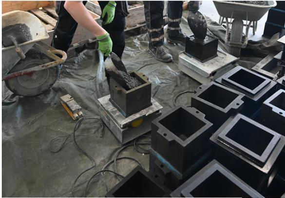
Abb. 23: Herstellen Probekörper
