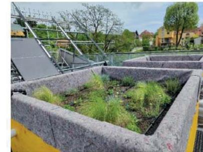
Testaufbau: Substrat 15cm, semi-intensive Begrünung
